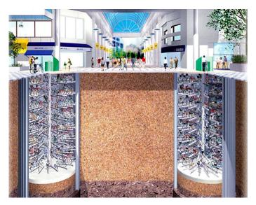
Figura 112: Estrutura de um estacionamento subterrâneo de bicicletas Fonte: CicloVivo.
