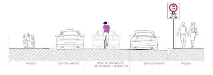
Seção 16: Ciclorrota - Espaços compartilhados Fonte: Tectran / Idom, 2013.
