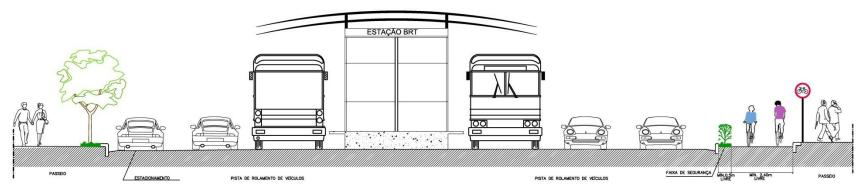
Seção 18: Ciclovia Bidirecional na via junto à calçada em via com operação do sistema de BRT Fonte: Tectran / Idom, 2013.
