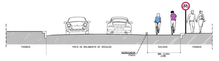
Seção 2: Ciclovia Bidirecional – Nível da via com segregador físico Fonte: Tectran / Idom, 2013.
