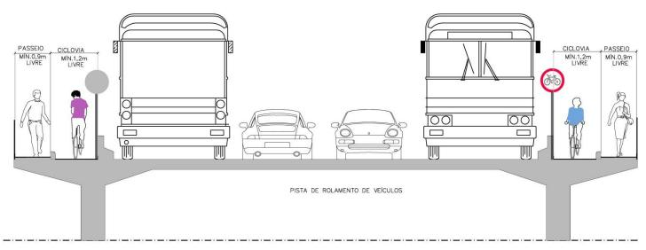
Seção 24: Ciclovia unidirecional sobre ponte ou viaduto Fonte: Tectran / Idom, 2013.
