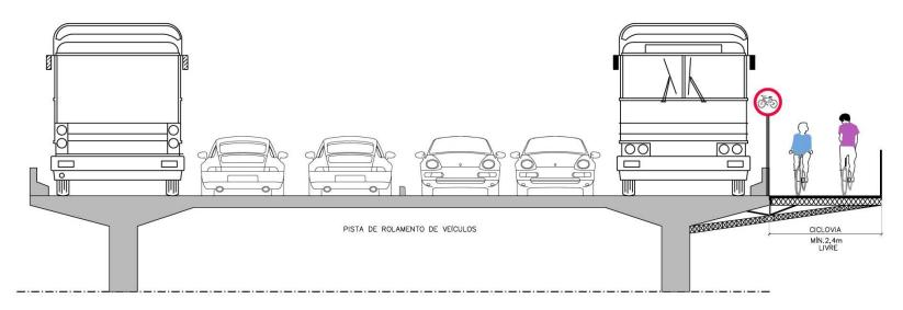
Seção 22: Ciclovia bidirecional sobre estrutura metálica construída anexa à ponte ou viaduto Fonte: Tectran / Idom, 2013.
