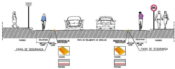
Seção 13: Ciciclovia Segregada em Calçada Unidirecional com dispositivo de sinalização Fonte: Tectran / Idom, 2013.
