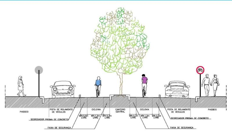
Seção 7: Ciclovia Unidirecional - Nível da via junto ao canteiro central com segregador físico Fonte: Tectran / Idom, 2013.
