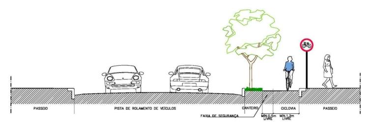
Seção 6: Ciclovia Unidirecional com existência de árvores Fonte: Tectran / Idom, 2013.
