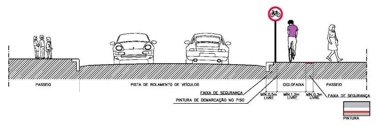
Seção 14: Ciclovia Segregada em Calçada Unidirecional – Nível da calçada com pinturas no piso Fonte: Tectran / Idom, 2013.
