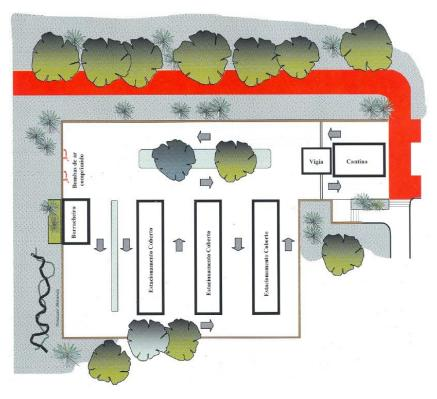
Figura110: Esquema com alto padrão de arranjo de um Bicicletário Fonte: MT. 2001.
