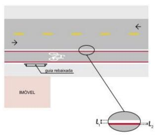
Figura 80: Marcação de ciclofaixa ao longo da via Fonte: CONTRAN, 2007.
