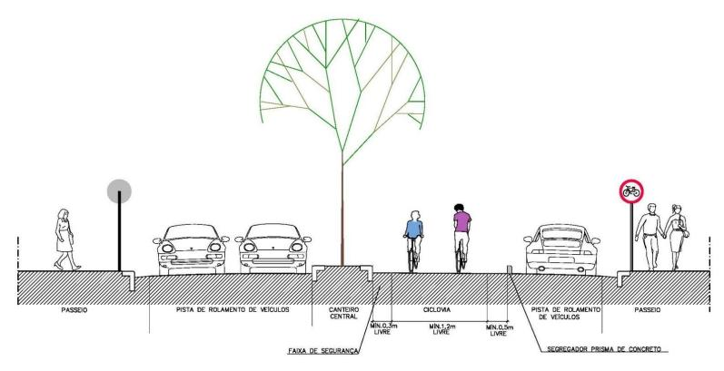
Seção 8: Ciclovia Bidirecional - Nível da via junto ao canteiro central com segregador físico Fonte: Tectran / Idom, 2013.
