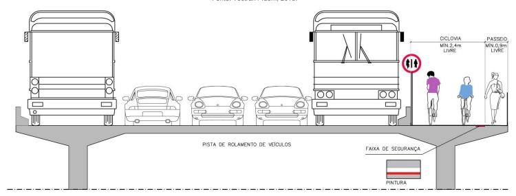
Seção 21: Ciclovia compartilhada com a calçada sobre ponte ou viaduto Fonte: Tectran / Idom, 2013.
