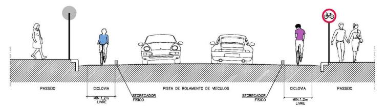
Seção 5: Ciclovia Unidirecional - Nível da via com segregador físico Fonte: Tectran / Idom, 2013.
