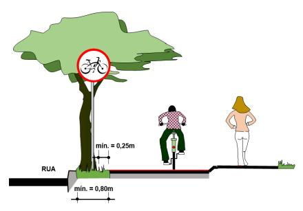
Figura 116: seção transversal de terraplenos. Plantio de árvores em área com até 80 cm Fonte: MT, 2001, adaptado por Tectran / Idom.
