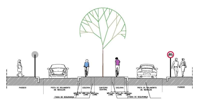
Seção 9: Ciclovia Unidirecional no canteiro central Fonte: Tectran / Idom, 2013.
