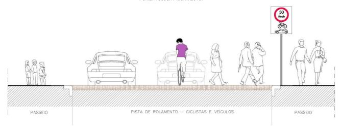
Seção 17: Ciclorrota - Espaços compartilhados com tratamento de *traffic calming* Fonte: Tectran / Idom, 2013.
