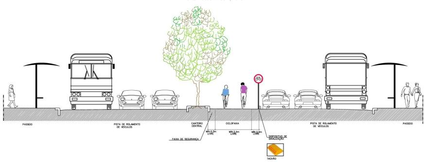
Seção 19: Ciclovia Bidirecional em via com canteiro central e circulação de transporte público Fonte: Tectran / Idom, 2013.
