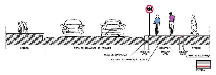
Seção 12: Ciclovia Segregada em Calçada Bidirecional – Nível da calçada com pinturas no piso Fonte: Tectran / Idom, 2013.
