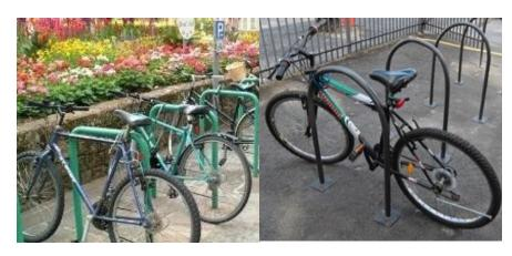
Figura 102: Suporte modelo Sheffield e modelo "U invertido" Fonte: ACBC, 2013.
