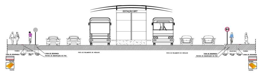
Seção 20: Ciclovia Segregada em Calçada em via com operação do sistema de BRT Fonte: Tectran / Idom, 2013.
