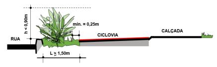
Figura 115: Seção transversal de terraplenos. Arbusto como barreira física Fonte: MT, 2001, adaptado por Tectran / Idom.
