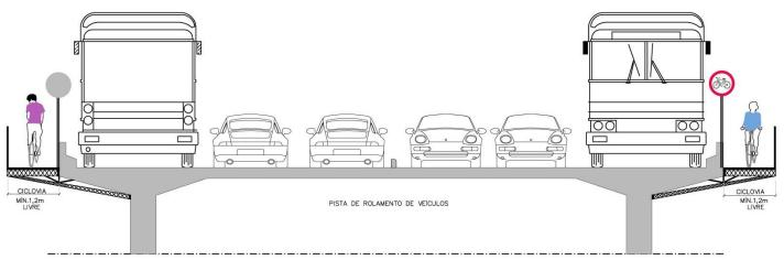
Seção 23: Ciclovias unidirecionais sobre estrutura metálica construída anexa à ponte ou viaduto Fonte: Tectran / Idom, 2013.
