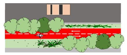
Figura 117: Árvores agrupadas em filas, alternadamente em cada lado da via ciclável. Fonte: MT, 2001, adaptado por Tectran / Idom.
