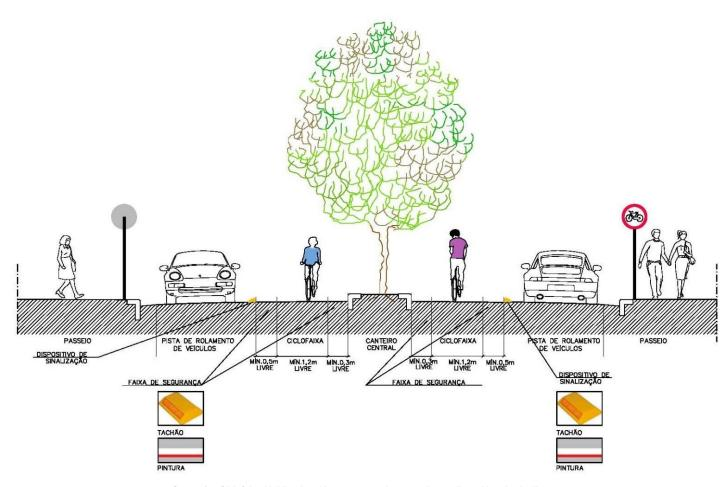
Seção 15: Ciclofaixa Unidirecional junto ao canteiro central com dispositivo de sinalização Fonte: Tectran / Idom, 2013.
