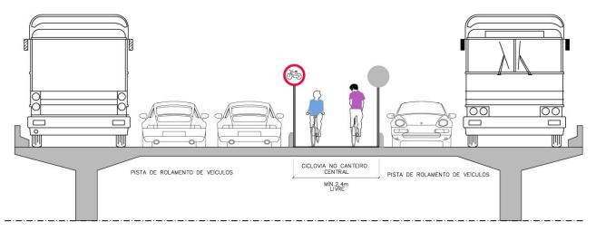
Seção 25: Ciclovia bidirecional implantada com função de canteiro central sobre ponte ou viaduto Fonte: Tectran / Idom, 2013.
